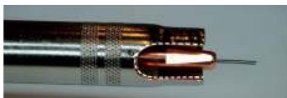
Неправильно. Наконечник выступает из газового сопла
