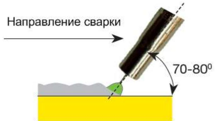
Правильно: сварка углом назад с наклоном горелки 70-80°
