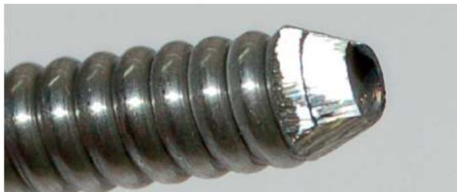
Проходное сечение контактного наконечника и проволокопровода должны соответствовать диаметру применяемой проволоки
