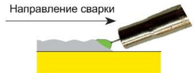
Неправильно: сварка углом назад, но угол наклона горелки слишком мал
