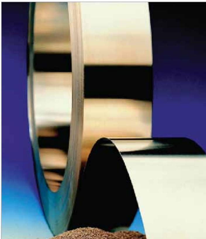
Электродные ленты ESAB поставляются в холоднокатаном состоянии в бухтах с внутренним диаметром 300 мм по 25 или 50 кг, а также 100-200 кг. Стандартная толщина ленты 0,5 мм при ширине 30, 60 и 90 мм. По согласованию с заказчиком ленты могут изготавливаться других размеров.
