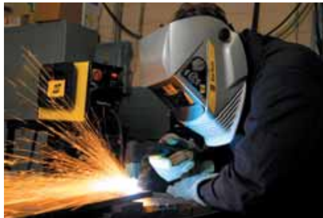
Строжка аппаратом PowerCut 1600 с горелкой PT-38
