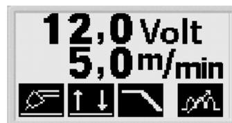
Доступ к меню установленных значений можно осуществить без потери измеренных значений. Это происходит только в том случае, когда повернута ручка отображения установленных значений вместо измеренных.
