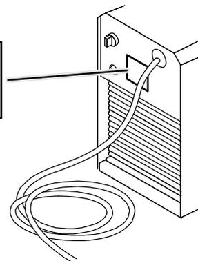
**ВНИМАНИЕ!** Этот источник сварочного тока рассчитан на подключение к четырехпроводной системе с напряжением 400 В.
