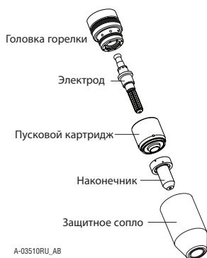
Части горелки
