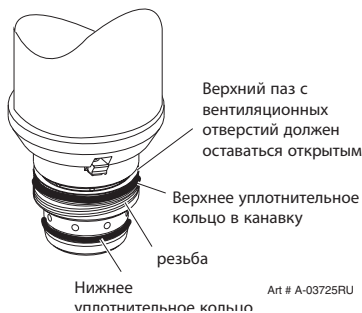
Уплотнительное кольцо головки горелки
