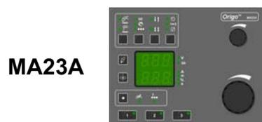
С вращаемыми ручками, предназначенными для установки напряжения / QSet™ и скорости подачи проволоки / силы тока. Остальные настройки производятся кнопками.
