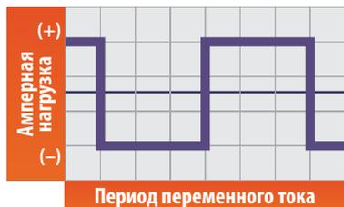
Прямоугольная волна имеет стабильную сварочную дугу, применяется для глубокого проплавления с быстрой скоростью прохода.
