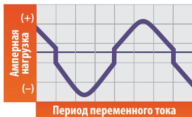
Синусоидальная волна обеспечивает мягкость дуги, менее шумная, обладает эффектом широкого, но в тоже время неглубокого расплавления основного металла.
