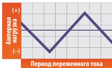
Треугольная волна обеспечивает быстрое образование сварочной ванны. Дает эффективность пиковой токовой нагрузки при уменьшении общего подвода тепла, ограничивает подводимую теплоту и уменьшает степень деформации сварочного шва. Хорошо подходит для сварки тонкого алюминия.
