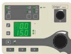
Ручки управления, предназначенные для установки напряжения и скорости подачи проволоки / силы сварочного тока. Настройка других параметров осуществляется при помощи кнопок.
