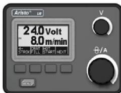
С вращаемыми ручками для установки напряжения и скорости подачи проволоки / силы тока. Другие настройки производятся с помощью кнопок, при этом на дисплее отображается текст.
