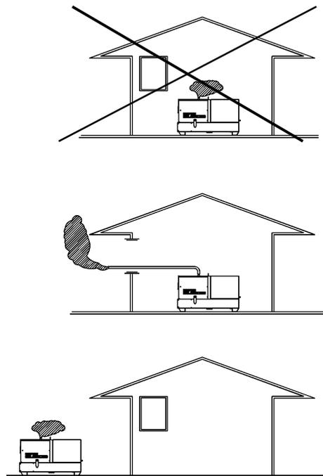
☞ Проверить, что горячий воздух и/или выхлопные газы машины удаляются, и что они не поступают обратно в машину, вызывая перегрев и недостаточное сгорание топлива.
