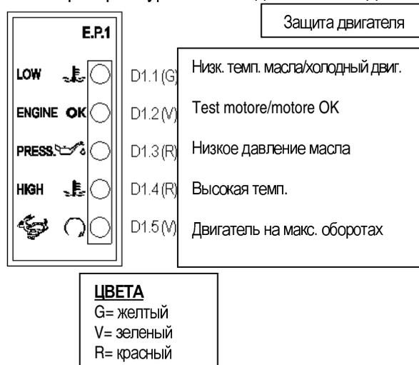
Прим.: Эта машина имеет ручной акселератор, который используется при выходе из строя EP1 или соленоид акселератора. Ручной акселератор может также использоваться, если функция включения минимальных оборотов не совместима с выполняемым типом сварки.
