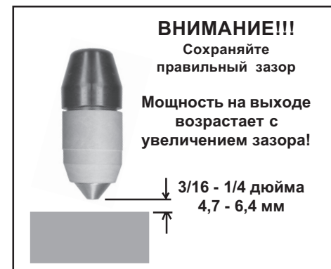
Рисунок 4-3. Зазор и мощность на выходе
