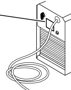
**ПРИМЕЧАНИЕ!** Этот источник сварочного тока рассчитан на подключение к четырехпроводной системе с напряжением 400 В.
