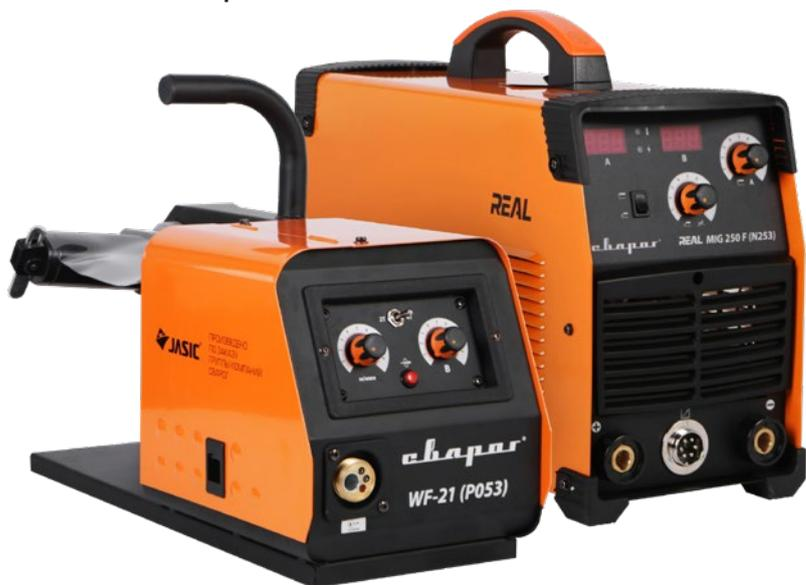
У аппарата REAL MIG 250F (N253) более стабильные выходные характеристики, за счет обновленной силовой части с использованием IGBT транзисторов и установленного дросселя с большей емкостью.
